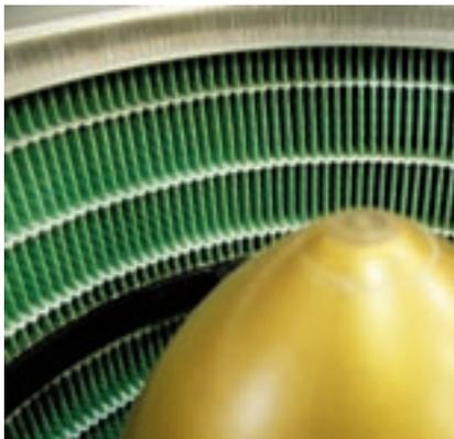
Camfil Farr APC Gold Series® Patronen besitzen eine größere Kapazität bedingt durch den patentierten inneren Konus (Gold Cone™). Dieser innere Konus vergrößert die Filterfläche und gewährleistet eine gleichmäßige Verteilung der Impulsabreinigung. Außerdem steht dem Filter mehr nutzbare Fläche für den Luftdurchsatz zur Verfügung.
