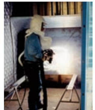
Thermisches- / Flammsprühen nach der Inbetriebnahme einer Gold Series®
