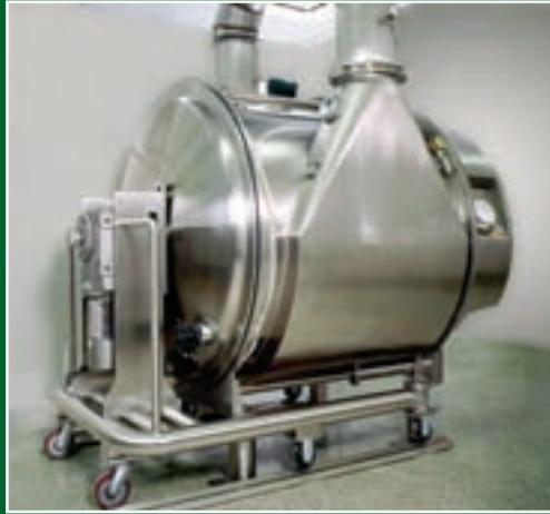
Camfil Farr APC „bag-in/bag-out“ Staubabscheider entfernen z.B. Staub aus Tablettenbeschichtungsanlagen wie diesem `Spectrum Coater`.
