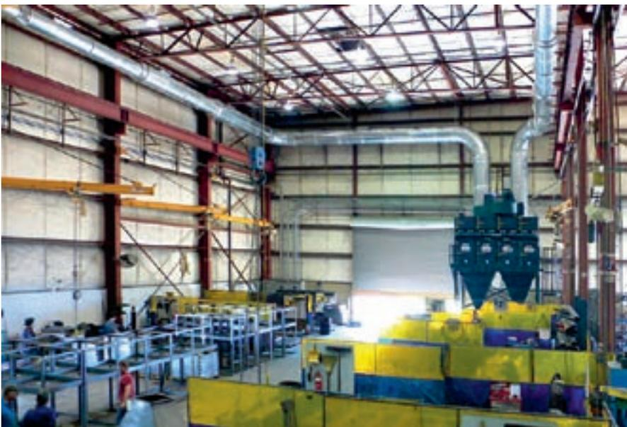
GS48 bei Schweißrauch mit integriertem HEPA Filter
