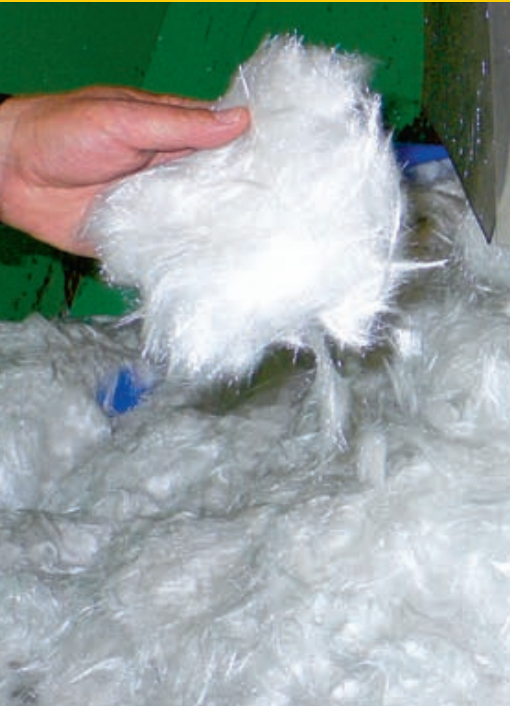
Glasfiber som används vid tillverkning av skrov till plastbåtar.
