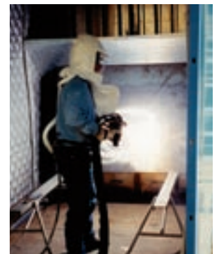
Termisk sprutbås när Gold Series® filtersystem är i drift
