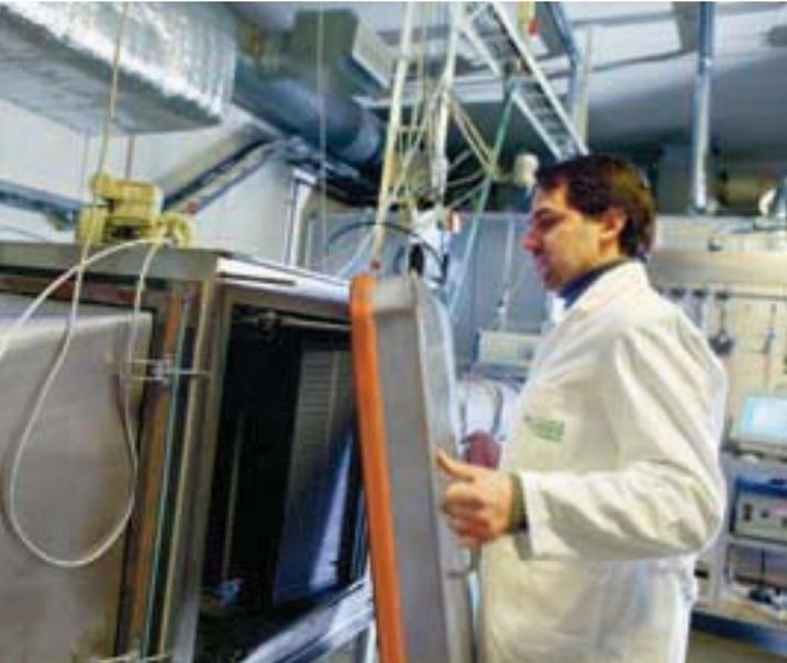
Banc d'essai des filtres moléculaires.
