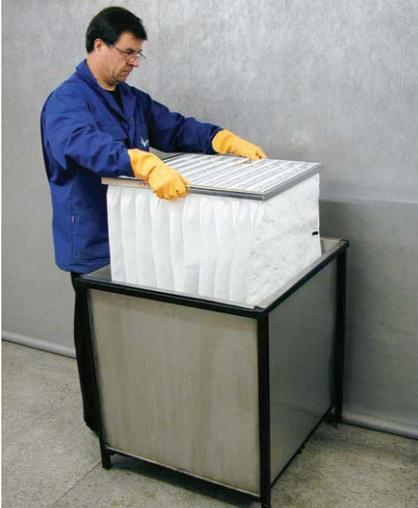
VTT Test Institut in Finnland, Entladung eines elektrostatisch aufgeladenen Filters mittels Isopropanol
