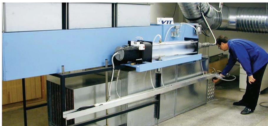
VTT-Prüfstand zum Filtertest gem. EN 779:2002, Finnland
