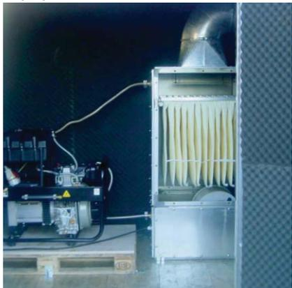
Dieselmotor zur Entladung eines elektrostatisch aufgeladenen Filters bei Camfil Farr
